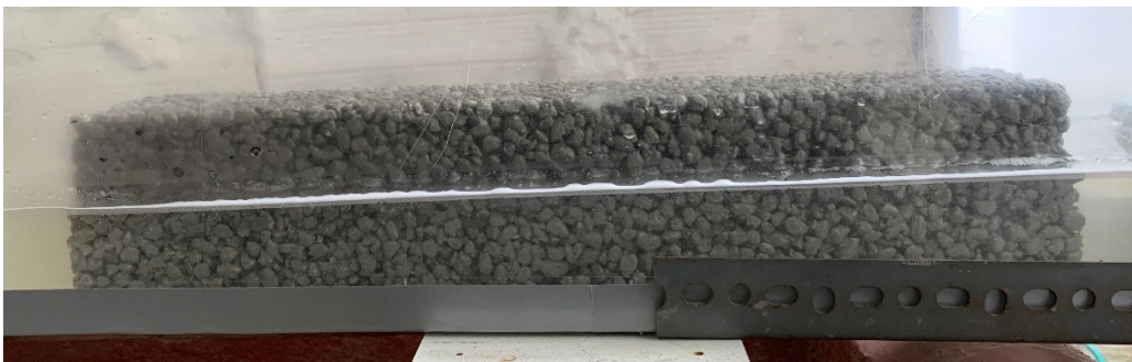
Figura 10. Probetas de hormigón permeable poroso para experimentos a escala
