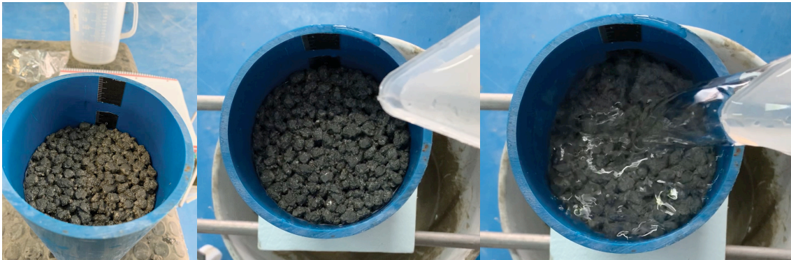
Figura 12. Prueba de infiltración normalizada ISO/FDIS 17785-1.2
